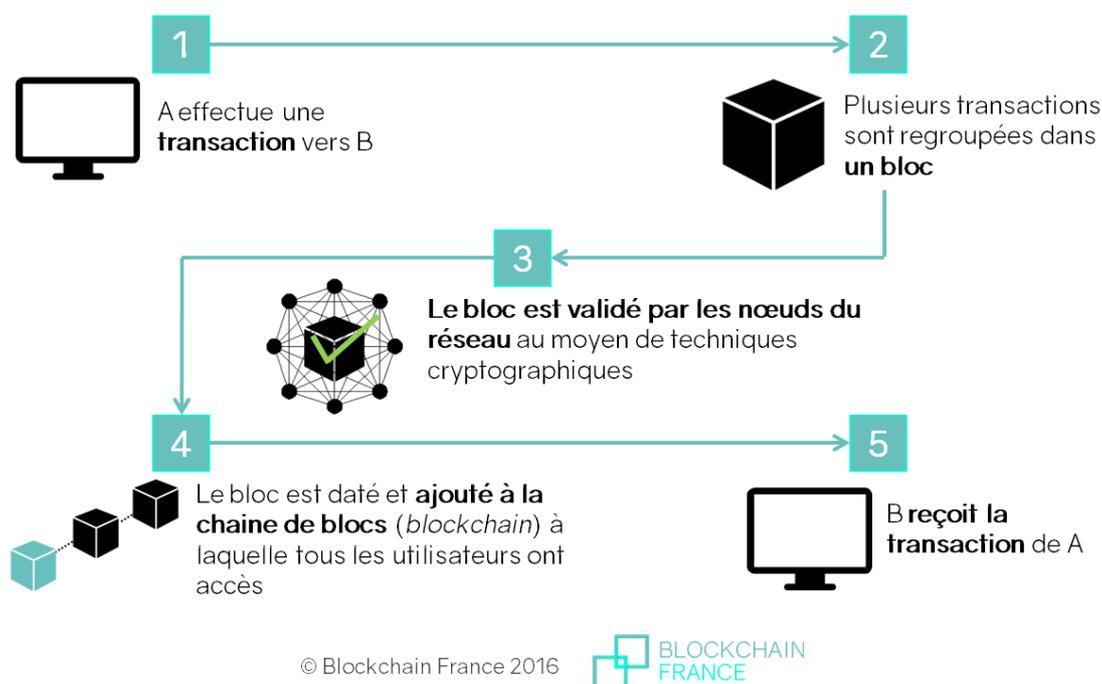
**Figure 2 - Scénario d'enregistrement d'un bloc (Blockchain France, 2016)**
